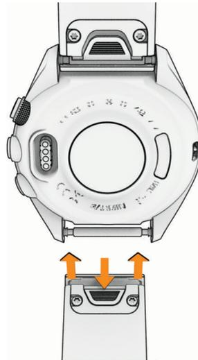
**HINWEIS:** Vergewissern Sie sich, dass das Armband sicher befestigt ist. Die Verriegelung sollte über dem Stift einrasten.
